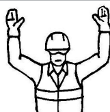
Peligro (alto o parada de emergencia)
