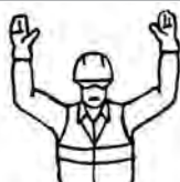
Peligro (alto o parada de emergencia)
