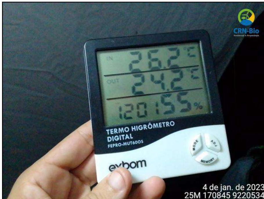
Figura 3.221: Uso de termohigrômetro digital para medição de variáveis climáticas, na área do Complexo Eólico Serra da Borborema, município de Pocinhos, PB.
