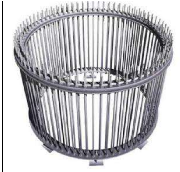
Figura 1.11: Vista 3D do anchor bolts Fonte: Memorial Descritivo – Complexo Eólico Serra da Borborema, 2023.
